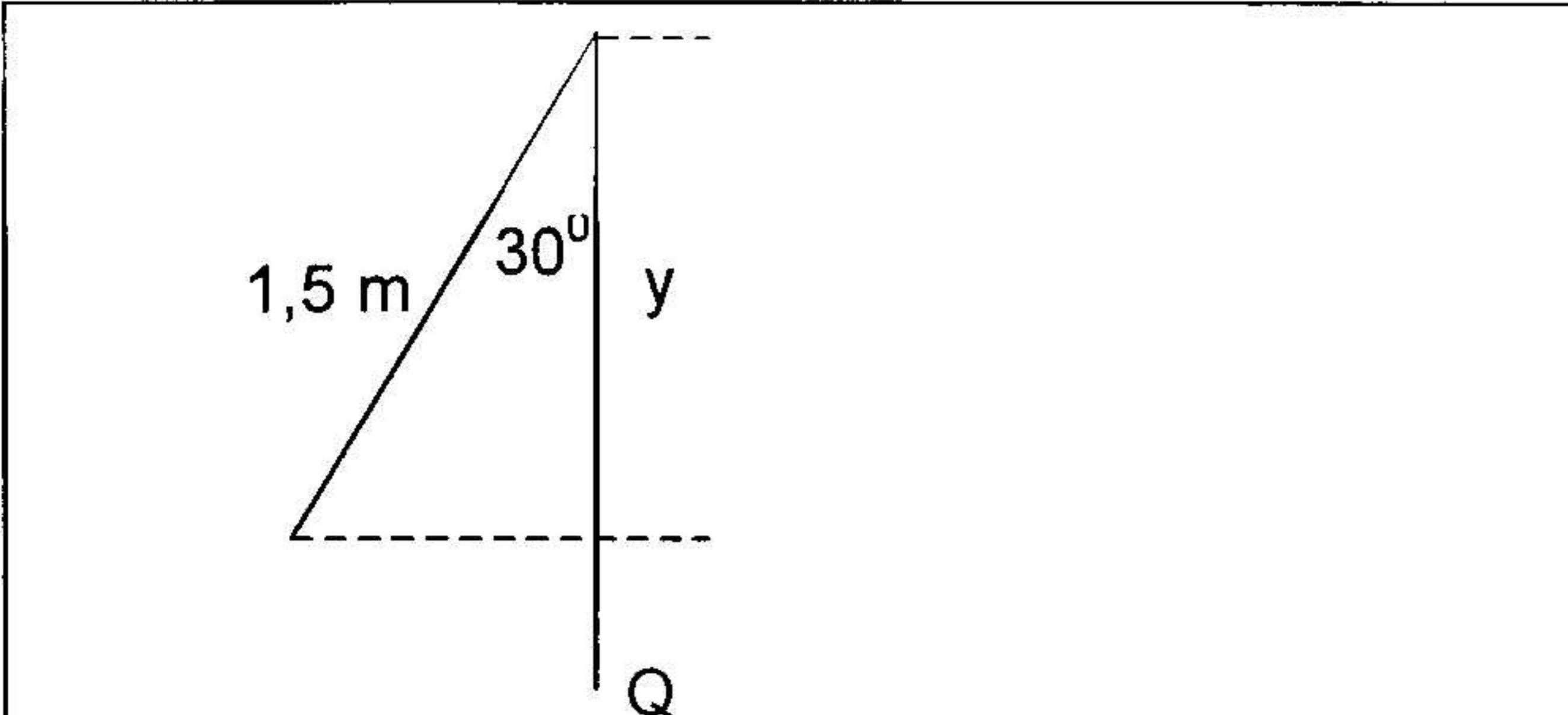
$$y = 1,5 \times \cos 30^\circ \quad \checkmark \\ = 1,3 \text{ m} \quad \checkmark$$
