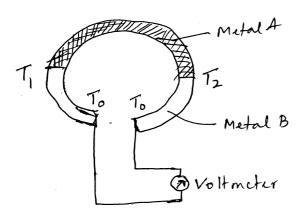
(Temperature  $T_1 \neq T_2 \neq T_0$ )
