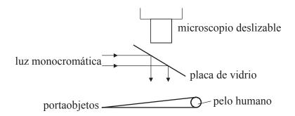
Se utiliza un pelo humano para separar dos portaobjetos de un microscopio. Un haz de luz monocromática se refleja hacia los dos portaobjetos por la placa de vidrio. La luz se refleja a continuación en los dos portaobjetos, se transmite a través de la placa de vidrio y es visualizada en el microscopio deslizable.
