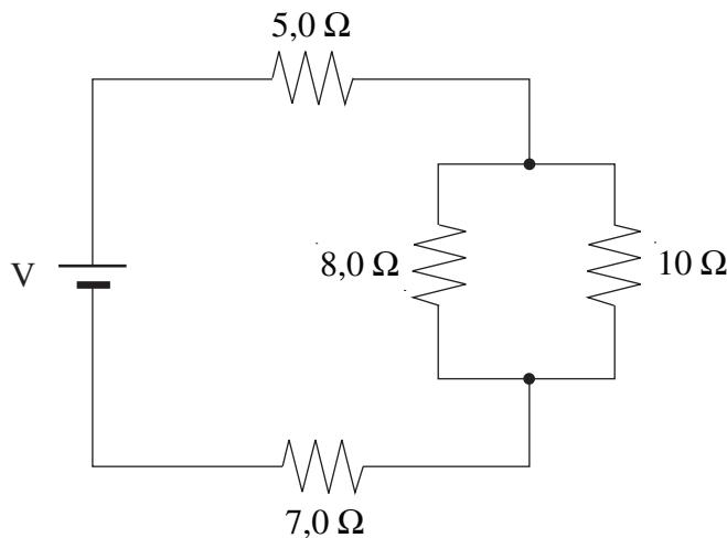
Dans ce circuit, on ajoute une résistance de  $4,0 \Omega$  placée en **série** avec la résistance de  $5,0 \Omega$ . Que devient la résistance équivalente du circuit et que devient l'intensité du courant dans la résistance de  $7,0 \Omega$  ?
