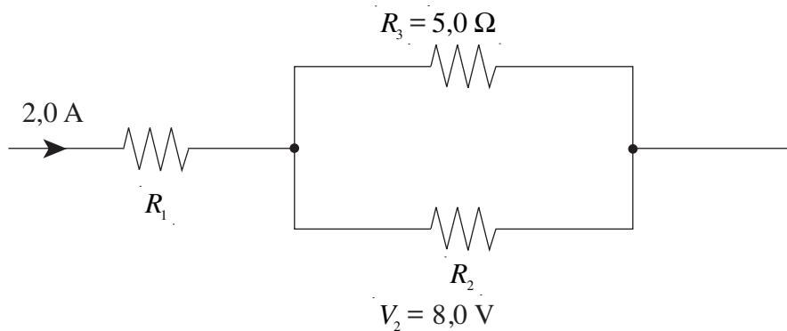
Quelle est l'intensité du courant qui traverse la résistance de  $5,0\Omega$ ?
