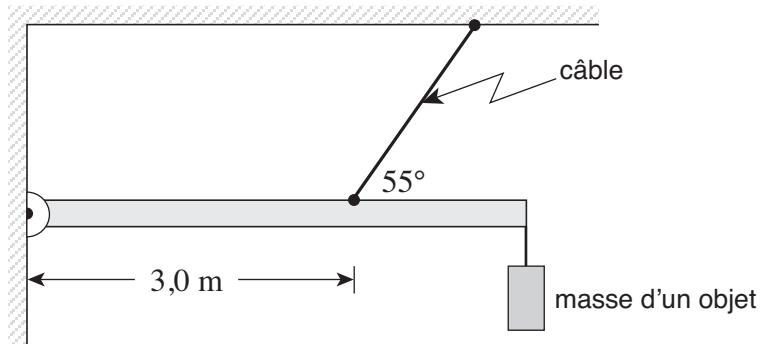
Le câble peut supporter une tension maximum de  $2,7 \times 10^3$  N . Quelle est la masse maximum d'un objet que l'on peut suspendre à l'extrémité de la poutre?
