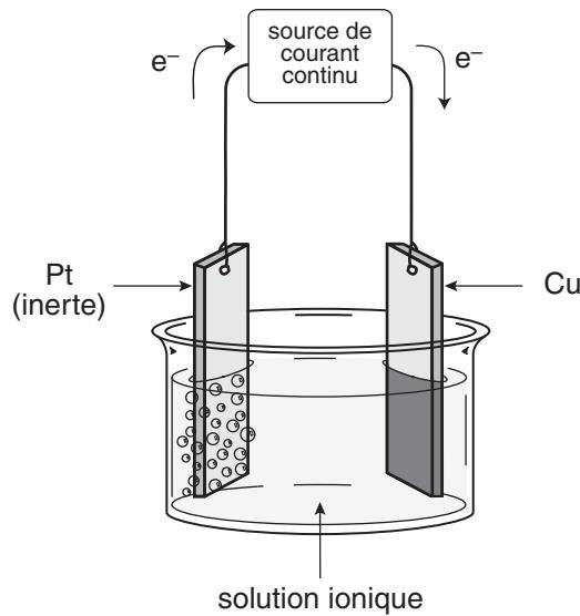
On observe le dégagement de bulles de gaz à l'électrode inerte ainsi que l'apparition d'un film métallique brillant à la surface de l'électrode de cuivre. Donne un exemple d'une solution ionique qui a pu être utilisée dans cette expérience. Fournis les équations des demi-réactions qui permettent d'expliquer ces résultats.
