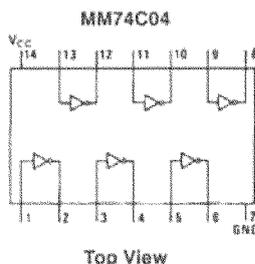
MM74C00 • MM74C02 • MM74C04 Quad 2-Input NAND Gate • Quad 2-Input NOR Gate • Hex Inverter
